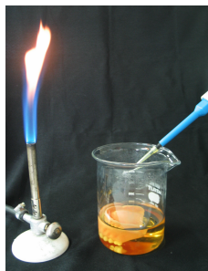
FIGURA 1 - Uma alíquota de 15µL correspondente a concentração de 10^7 ufc/mL meio de cultura inoculado com C.dubliniensis foi pipetada em cada um dos béqueres contendo as próteses totais esterilizadas
